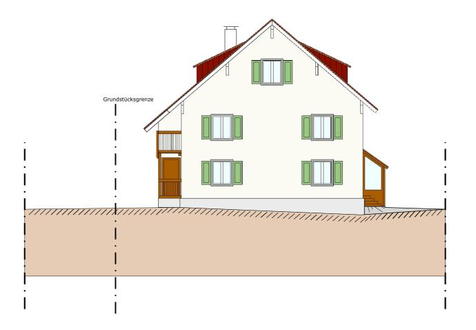
Zurückbau Dachstuhl für Erstellung Balkon, sowie Ausbau Dachstuhl
