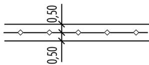
**Haupt-Versorgungsleitungen** unterirdisch, hier 20-kV-Erdkabel der Seeallianz GmbH & Co. KG mit der Festsetzung eines Leitungsrechtes zu Gunsten des Versorgungsträgers; innerhalb des Schutzstreifens sind bauliche Anlagen (z.B. auch Dauerstellplätze) unzulässig. Eine andere Nutzung ist nur nach Prüfung und gegebenenfalls Zustimmung der Seeallianz GmbH & Co. KG zulässig. Der Zugang zum Mast muss für betriebliche Belange jederzeit gewährleistet sein.
